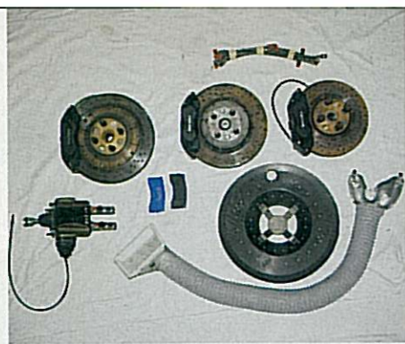
Sono tre i dischi freno anteriori, sopra, disponibili per una Delta 16V Gruppo A, a fianco. Nel vano posteriore c'è il serbatoio di sicurezza, a destra, all'interno del quale sono «affogate» le pompe benzina. Grandi possibilità di scelta per la trasmissione, sotto, con tre tipi di differenziale posteriore e due alberi di trasmissione. Sotto a destra c'è il motore 16 valvole (FotoPress)
